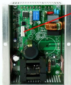
7 way pin header H1
